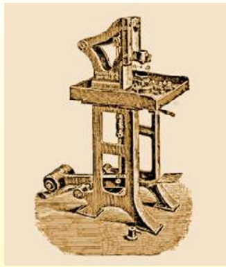
Pressa tedesca a pedale per porcellana elettrica (1905 La Céramique Industrielle, A. Granger, Ultimheat Museum)
