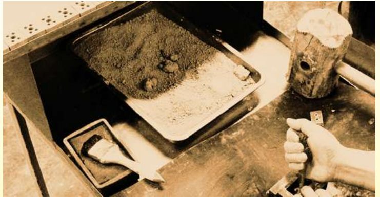
Blocchi terminali in porcellana realizzati a mano mediante pressatura a martello: Riempiimento manuale del granulato umido (Collezione privata) Essiccazione della porcellana elettrica dopo la pressatura (Collezione privata)
