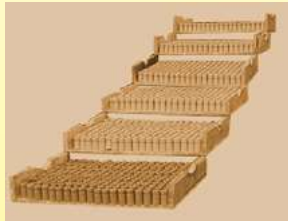
Essiccazione di isolatori in porcellana dopo la pressatura manuale a martello (Collezione privata)
