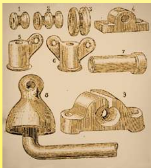
1885 Isolatori elettrici in porcellana (La physique moderne: l'électricité dans la maison, É. Hospitalier)
