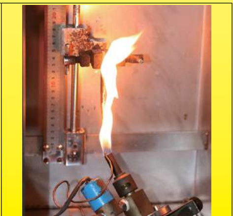
Campione durante il controllo UL94VO
