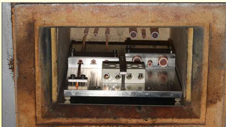
Forno di test per la resistività della ceramica in funzione della temperatura (Laboratorio Ultimheat)
